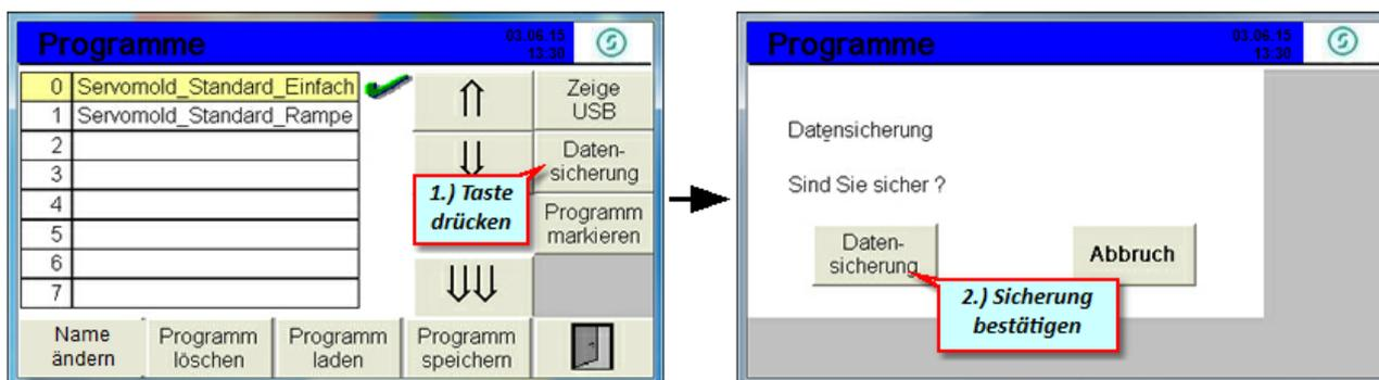
Bild 98 Datensicherung
