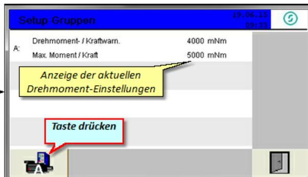
Bild 51 Setup - Gruppe A - Drehmomentüberwachung
