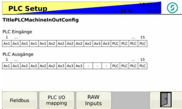
Bild 48 Setup - PLC - Hardware - PLC I/O mapping --> Zuordnung Ein- und Ausgänge
