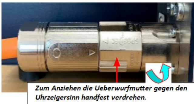
Anschluss Motorleitung an Motor
