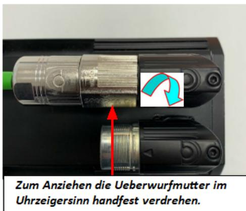
Bild 7 Signalleitung anschließen
