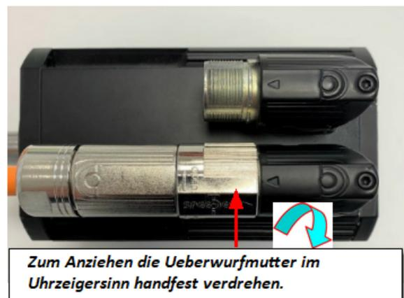
Bild 6 Motorleitung anschließen
